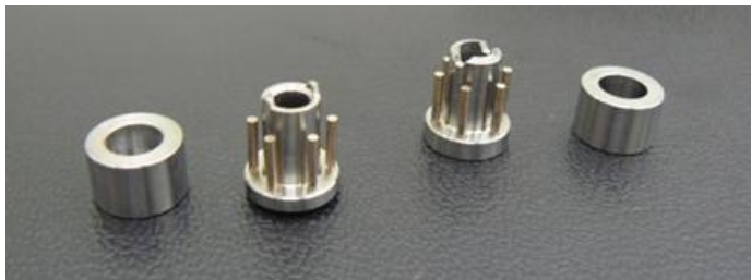
制振ダンパーに収められている針金状のCu-Al-Ni単結晶形状記憶合金
